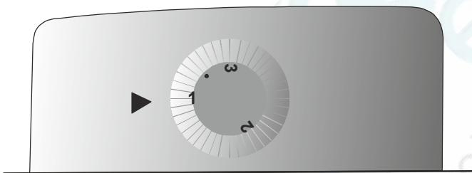
Термостат камеры замораживания автоматически регулирует температуру внутри камер. При вращении ручки из положения 1 в положение 3 достигается более низкая температура. Положение «•» показывает, что термостат выключен и охлаждения не будет.
